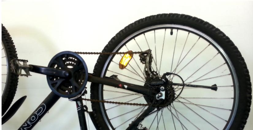
**Wellenrad** = Drehachse, an der mehrere Zahnräder befestigt sind
