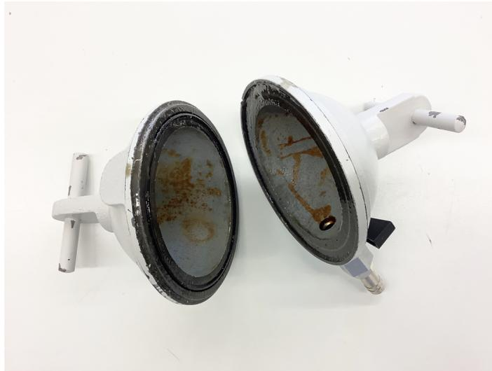
Durch Zusammenlegen der Kugeln entsteht ein Hohlraum, aus dem Luft herausgepumpt werden kann. Der mittlere Luftdruck beträgt in Meereshöhe  $1013,25 \text{ hPa}$ . Angenommen, der Druck in der Kugel beträgt nach dem Herauspumpen noch  $9 \text{ mbar}$ . Die Kugel hat einen Durchmesser von ca.  $10 \text{ cm}$ .
