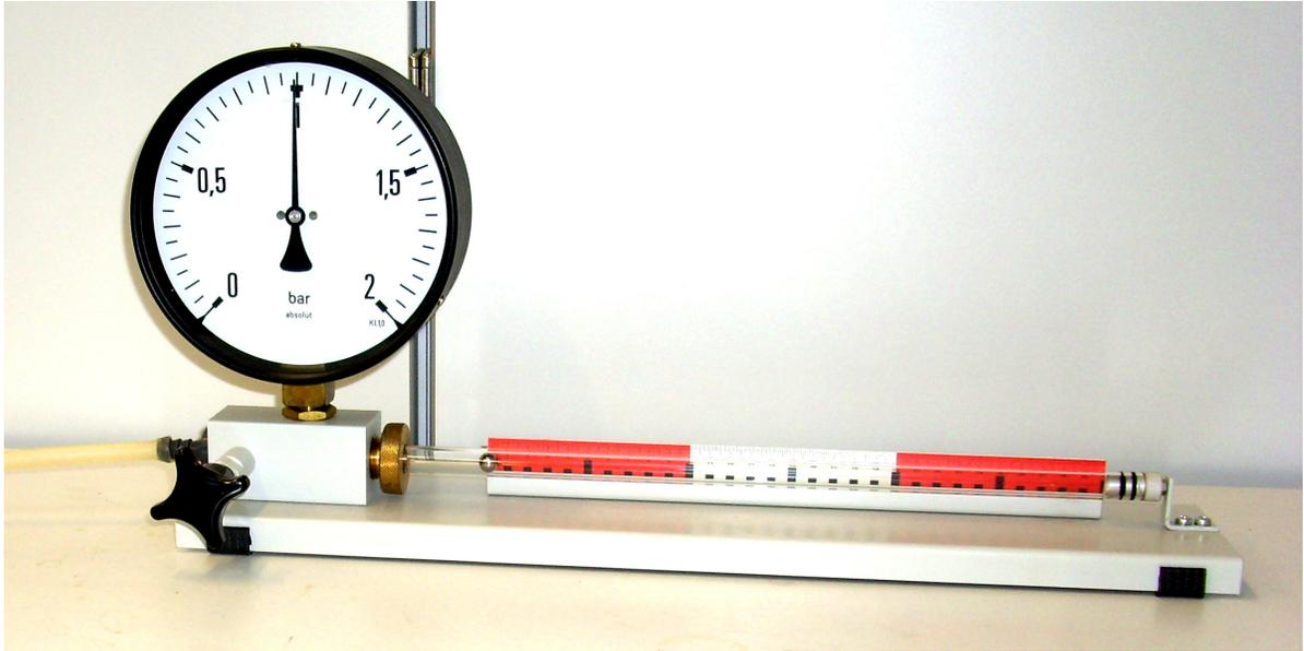
Das Glasrohr im Experiment hat einen Radius von  $r = 0,75\text{cm}$ . Damit ergibt sich für die Querschnittsfläche  $A$  gerundet auf die zweite Nachkommastelle  $A = \pi r^2 \approx 1,77\text{cm}^2$ . Die Skala hat eine Länge von  $L = 30\text{cm}$ . Wenn sich die Metallkugel bei der Nullmarkierung befindet, sind also etwa
