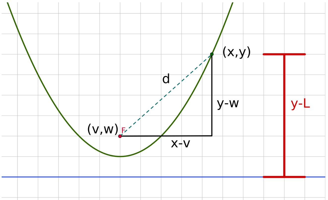
Seien  $(v, w)$  die Koordinaten des Brennpunktes  $F$  und  $y = L$  die Funktionsgleichung der Leitlinie, dann ist der Abstand  $d$  von  $F$  zu einem Punkt  $(x, y)$  auf der Kurve gegeben durch:
