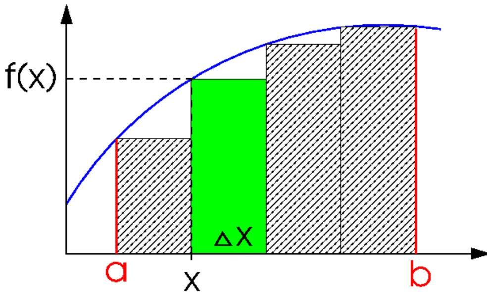
Sei  $f \geq 0$  für alle  $x \in [a, b]$ . Die Fläche  $A$  unter der Kurve  $f$  wird in  $n \in \mathbb{N}$  Rechtecke (in der Abbildung  $n = 4$ ) aufgeteilt. Jedes Rechteck hat die Breite  $\Delta x$ , ein Rechteck an der Stelle  $x$  hat den Flächeninhalt  $f(x) \Delta x$ . Man summiert die Flächen aller  $n$  Rechtecke auf, um einen Näherungswert für  $A$  zu erhalten:
